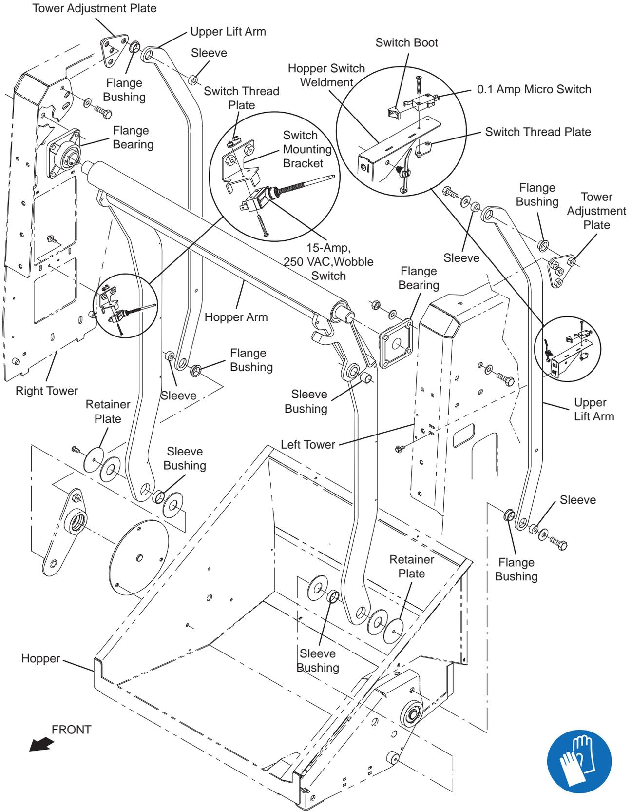
REPLACING THE HOPPER LIFT CYLINDER
