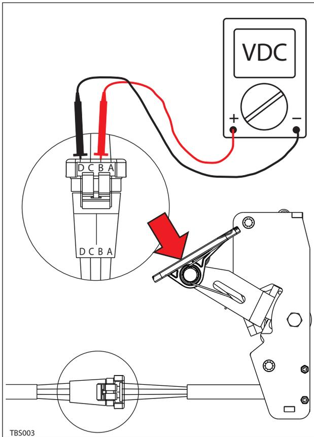
**TESTING THE SIDE SWEEP ACTUATOR(S)**
