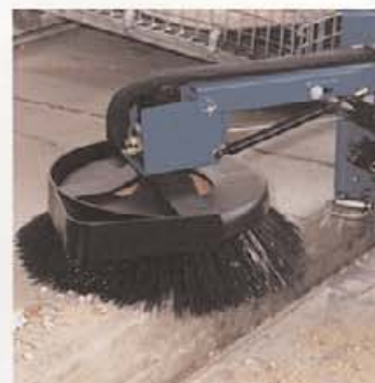
當主刷在清掃平坦街道的時候，SB2 輔助邊刷可清掃上面人行道緣飾。
