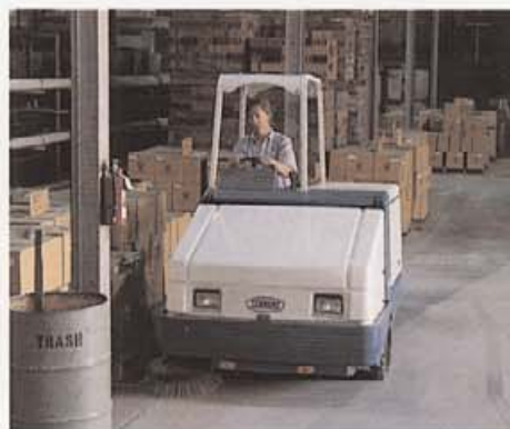
二段式清掃控制著地面上各形垃圾塵土，無論是四周圍表面或凹凸不平地面都可清掃乾淨。
