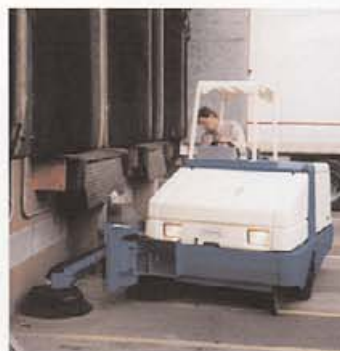
6550 型選擇性配備 SB2 輔助邊刷，可清掃一般邊刷無法清掃到的地方。
