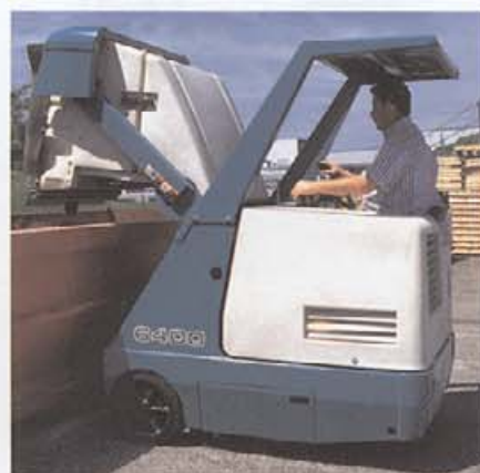
堅固的頂棚護架經保險商試驗所測試，能保護操控者的安全。
