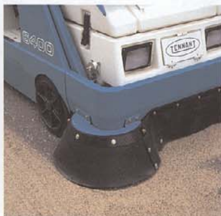
在清理多塵場地時，裝備邊刷防塵罩可防止灰塵四處揚散保持貨物清潔。
