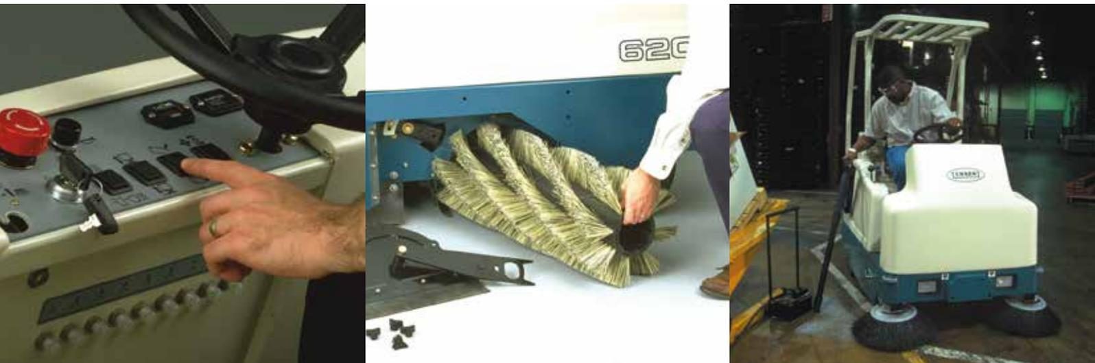
Gebaut mit Tennants hochwertigen Teilen und Konstruktion kann man die 6200 nahezu pausenlos einsetzen. Erwarten Sie erhöhte Produktivität mit effizientem Überkopfkehrsystem und stufenloser Hochentleerung.
