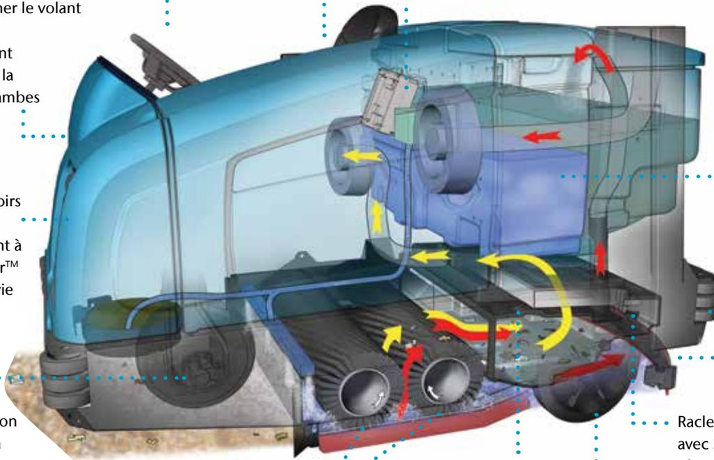
La brosse de récurage latérale permet d'élargir la voie de nettoyage de 48 po/1 220 mm jusqu'à 64 po/1 625 mm.
