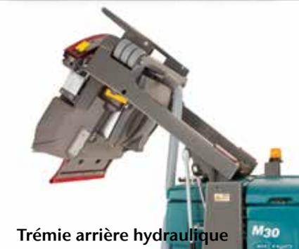
Trémie arrière hydraulique
