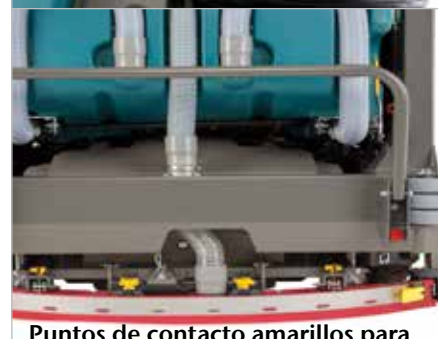
Puntos de contacto amarillos para mantenimiento
