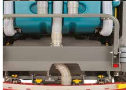
Puntos de contacto amarillos para el mantenimiento
