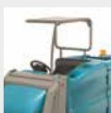
A proteção superior certificada em termos de **FOPS** (Falling Object Protective Structures [Estruturas de Proteção contra Quedas de Objetos]) ajuda a proteger o operador contra a queda de objetos.
