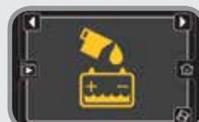
La technologie Smart-Fill™ en option indique à l'opérateur lorsqu'il est temps de remplir le réservoir d'eau pour éviter que la machine fonctionne sur des batteries sèches
