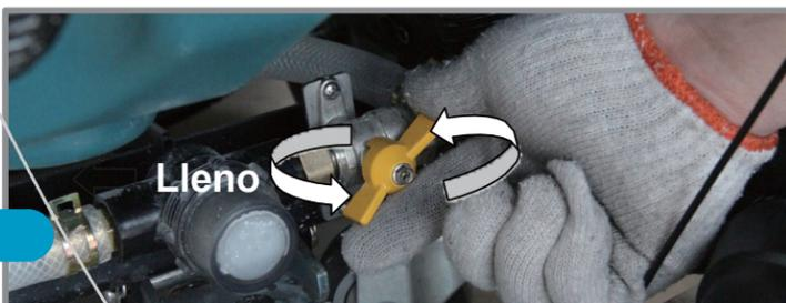
Ajuste la válvula de agua de ser necesario
