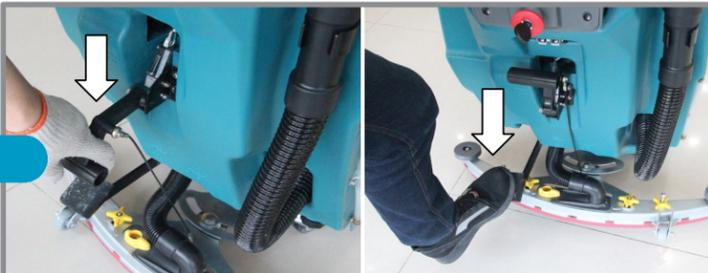
Baje el recuperador de agua y baje el cabezal de restregado
