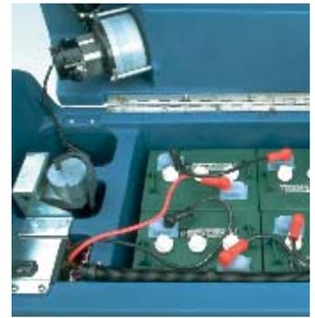
La sencillez es primordial en el diseño del modelo 5400. Simplemente levanta la cubierta para tener fácil acceso al motor aspirador, al sistema ES, al proveedor de energía de 24 voltios y a otros componentes vitales.
