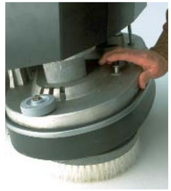
El cambio de cepillos es fácil. Con poca presión sobre el mecanismo exclusivo el cepillo se suelta fácilmente para ser cambiado.
