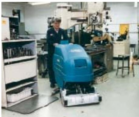
La máquina 5400 elimina el pre-barrido. Los cepillos cilíndricos recogen basura ligera.
