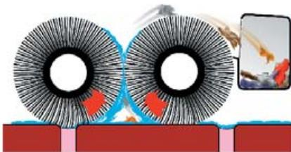
Las cabezas de los cepillos cilíndricos restregan baldosa y pisos dispares, mientras que simultáneamente recogen basura pequeña y ligera.
