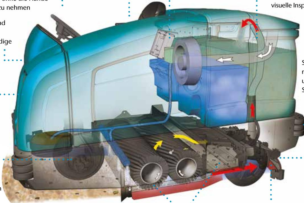
Kehrwalzen und ein einfach zugänglicher Kehrgutbehälter für maximale Produktivität
