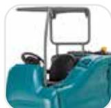
A proteção superior certificada em termos de FOPS (Falling Object Protective Structures [Estruturas de Proteção contra Quedas de Objetos]) ajuda a proteger o operador contra a queda de objetos.
