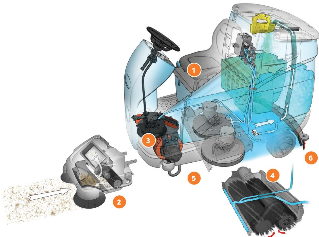
**1. Mantenha o compartimento do operador arrumado** para alcançar novos níveis de produtividade. A rede de carga lateral e o compartimento para acessórios amovível ajudam o operador a manter-se organizado e a manter o compartimento livre de resíduos.
