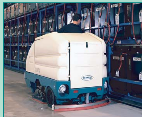
7300は洗浄ヘッドが約130mm右側に移動し、パレット、ラック横もスムーズに洗浄します。
