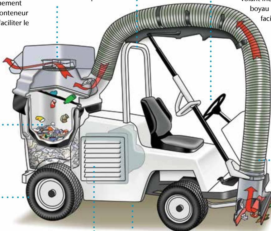
Quatre pneus tout terrain maximisent la mobilité et minimisent la compaction du sol.
