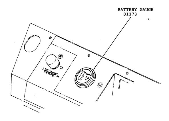
Fig. 1 - LOCATION OF BATTERY GAUGE
